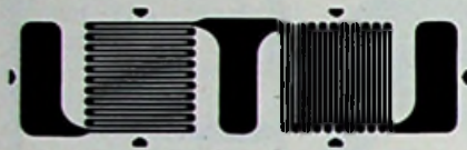
Links: Fig. 16. Rekstrookje in twee richtingen (opgedampte metaalfilm). Weerstand 120 \Omega \pm 0,5 \% . Rekbereik 5000-20 000 m/m (afhankelijk van typelineariteitsfout 1-2%). (IMP Hannover)
